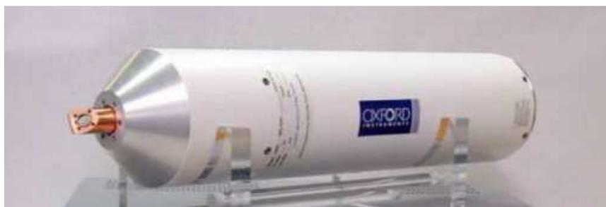
**Figure 2.5** Photographie de la source de rayons X Oxford Instruments.
