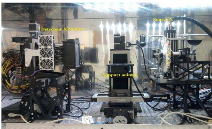
**Figure 2.2** Photographie du micro-tomodensitomètre PIXSCAN II.
