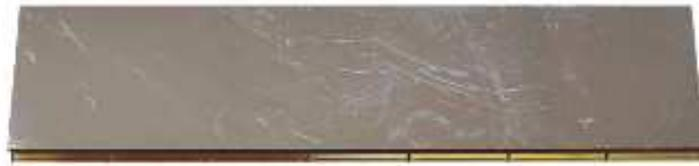
**Figure 2.13** Photographie d'une barrette constituée d'un capteur de silicium pixellisé hybridé à 7 chips XPAD3 (Dawiec, 2011).
