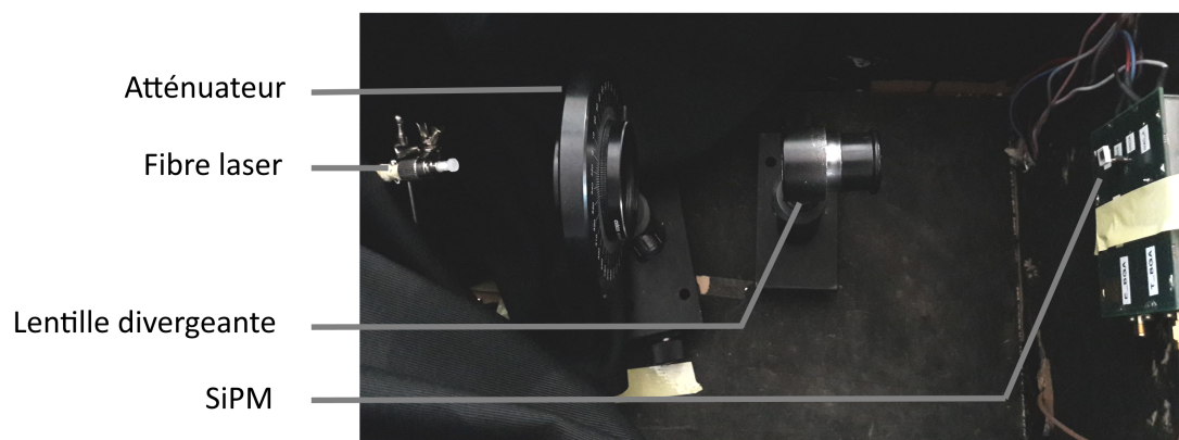
Figure 3.23. – Montage optique pour la mesure de la SPTR. Notons que les parois sont peintes en noir pour limiter la diffusion des photons optiques.
