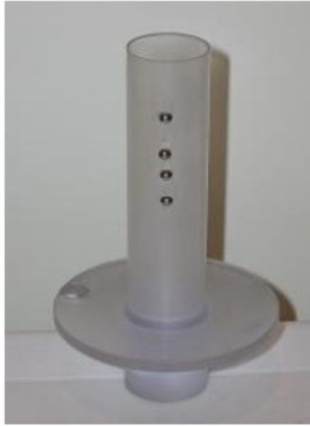
FIG. 2.13 – Fantôme de calibration utilisé pour l’alignement du PIXSCAN.
