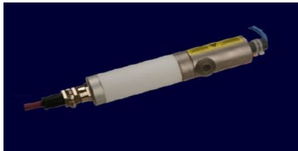
FIG. 2.2 – Tube à rayons X RTW MCBM 65B-50 Mo installé sur le PIXSCAN (longueur 228\text{ mm} , diamètre 40\text{ mm} ).
