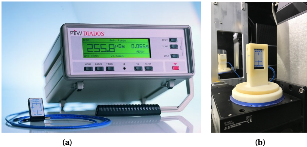
FIGURE 2.34 – Photos du dosimètre Diados utilisé pour l’estimation de la dose délivrée (a) et de l’installation du détecteur utilisé, sur le plateau rotatif du prototype PIXSCAN-FLI (b).
